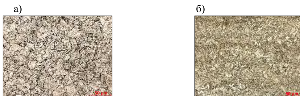
Рис. 1. Структура оправок из стали 17X5МА, термически обработанных по базовому режиму (а) и по опытному режиму (б)
