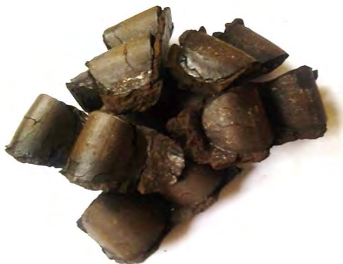
Рис. 2. Брикеты из торфа, полученные на валковом прессе с использованием подпрессовщика
