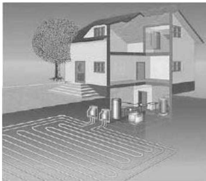
Рис. 3. Схема установки теплового насоса типа «грунт – вода» с горизонтальным расположением испарителя в грунте
