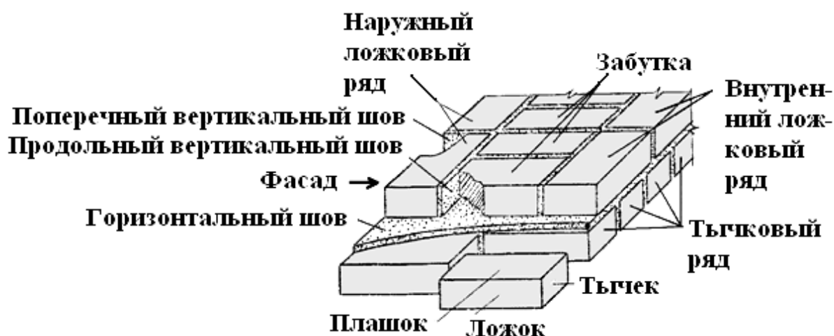
Рис. 1. Элементы каменной кладки
