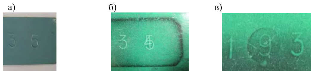
Рис. 2. Образец с измененной цифрой 4 на цифру 5 (а) и соответствующий ему индикаторный рисунок на пленке (б); индикаторный рисунок вырезанного и развернутого фрагмента панели с перевернутой цифрой 6 (в)
