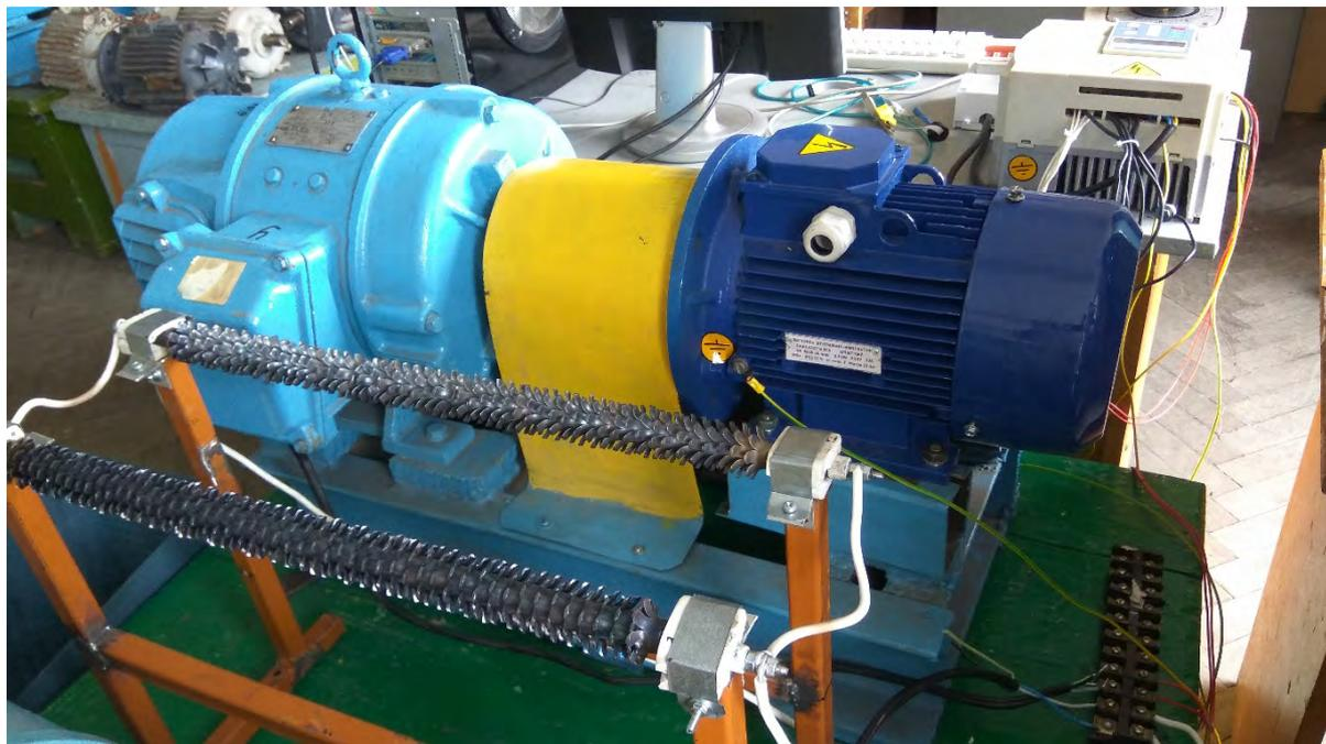
Рис. 1. Стенда для исследования вентильно-индукторного привода
