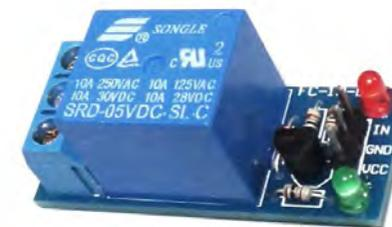
Рисунок 8.1 – Внешний вид реле SRD-05VDC
