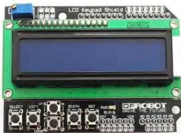
Рисунок 7.5 – Жидкокристаллический индикатор WM-C1602N с клавиатурой
