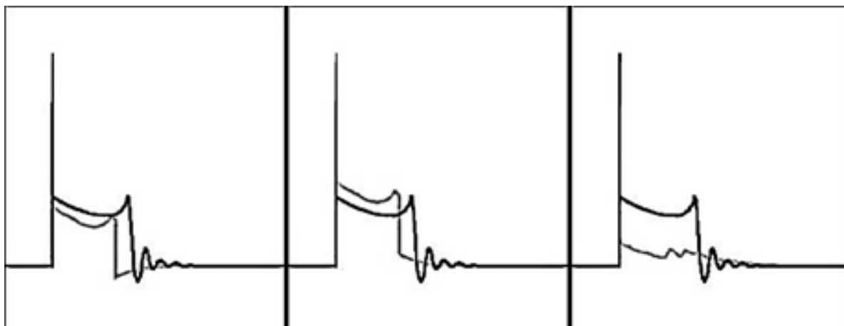
Рисунок 2.2 – Обрыв высоковольтного провода между катушкой зажигания и точкой установки емкостного датчика
