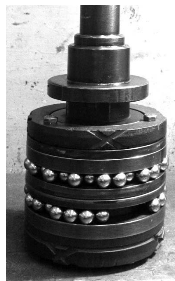
Рис. 1. Упрощенная схема и фотография двухрядного шарикового накатника пневмоцентробежного действия
