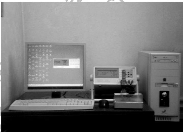
Рис. 1. Экспериментальная установка для контроля и диагностики комплекса диэлектрических свойств электроизоляционных материалов в диапазоне частот электрического поля 50 Гц – 1 МГц
