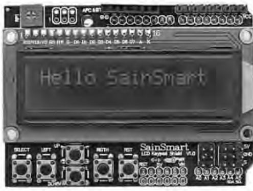
Рисунок 5.4 – Внешний вид жидкокристаллического индикатора (ЖКИ) WM-C1602N с клавиатурой
