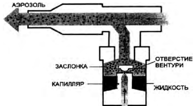
Рисунок 3.3 – Схема компрессорного небулайзера
