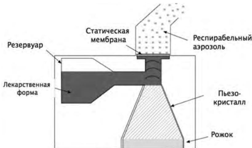
Рисунок 3.10 – Устройство небулайзера с «пассивной» вибрацией мембраны
