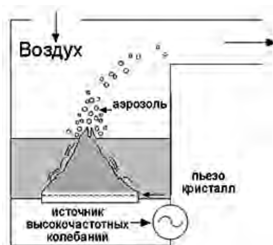
Рисунок 3.7 – Схема ультразвукового небулайзера
