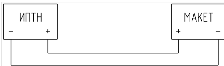
Рисунок 3.1 – Схема подключения макета
