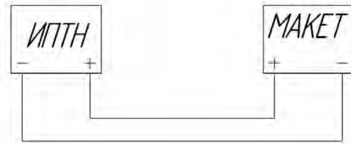
Рисунок 2.1 – Схема подключения макета
