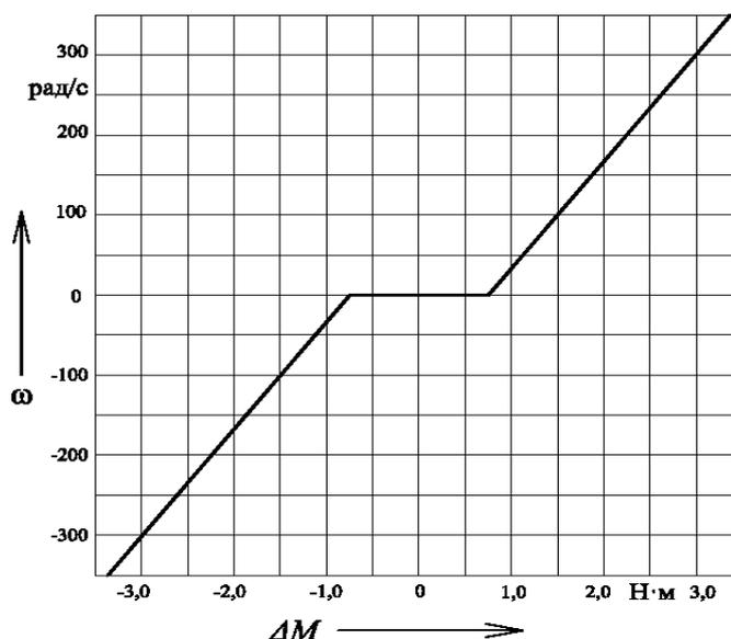
Рисунок 15 – Зависимость  $\Delta M = f(\omega)$  для двигателя М1 при номинальном токе возбуждения
