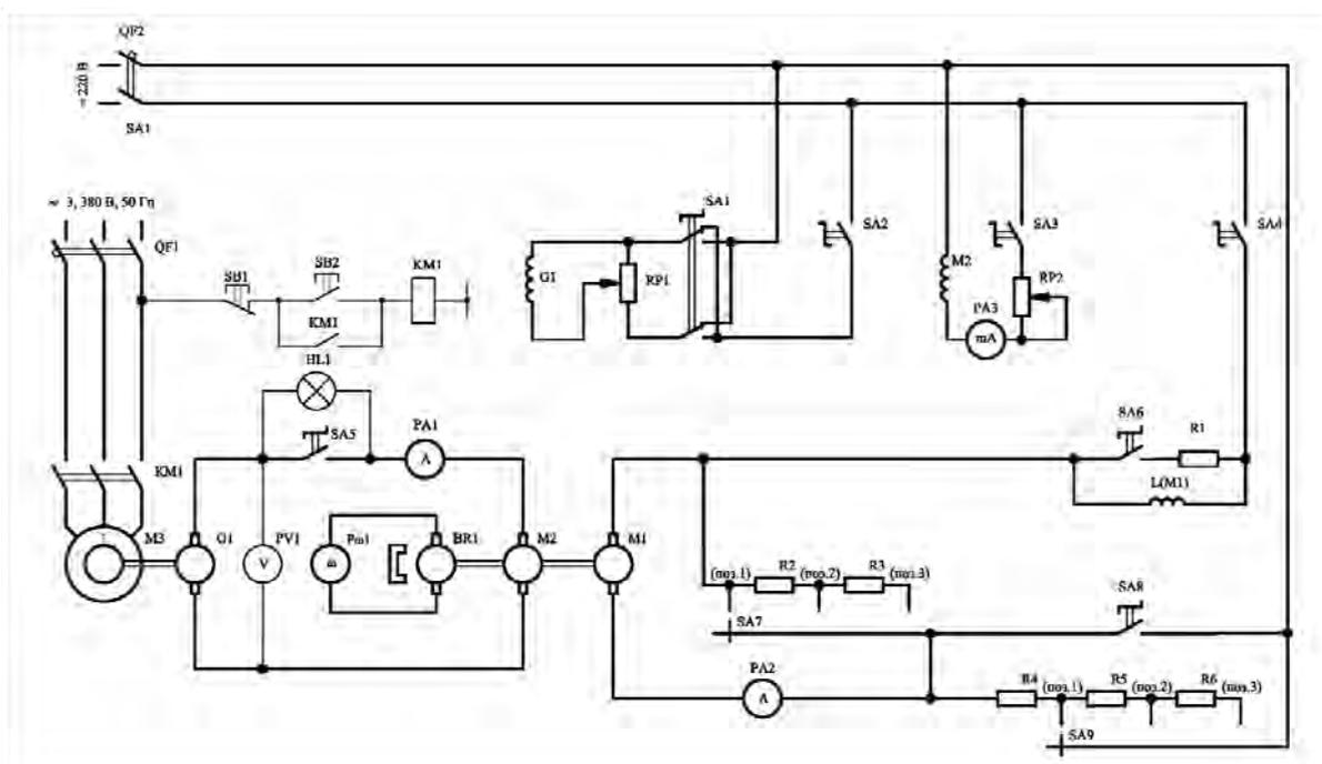
Рисунок б – Схема для исследования механических характеристик двигателя постоянного тока последовательного возбуждения
