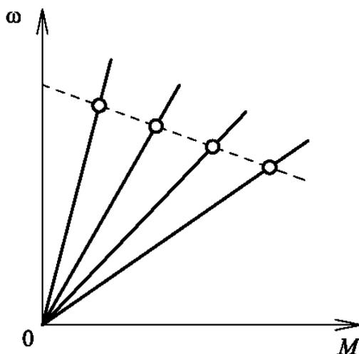
Рисунок 3 – Механические характеристики нагрузочного устройства А
