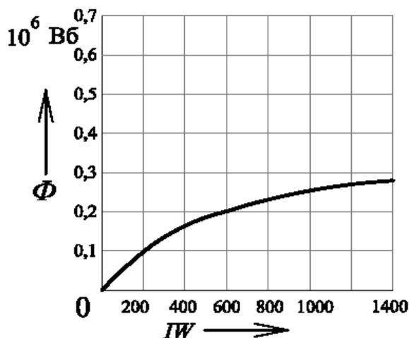
Рисунок 13 – Кривая намагничивания двигателя ПС-42
