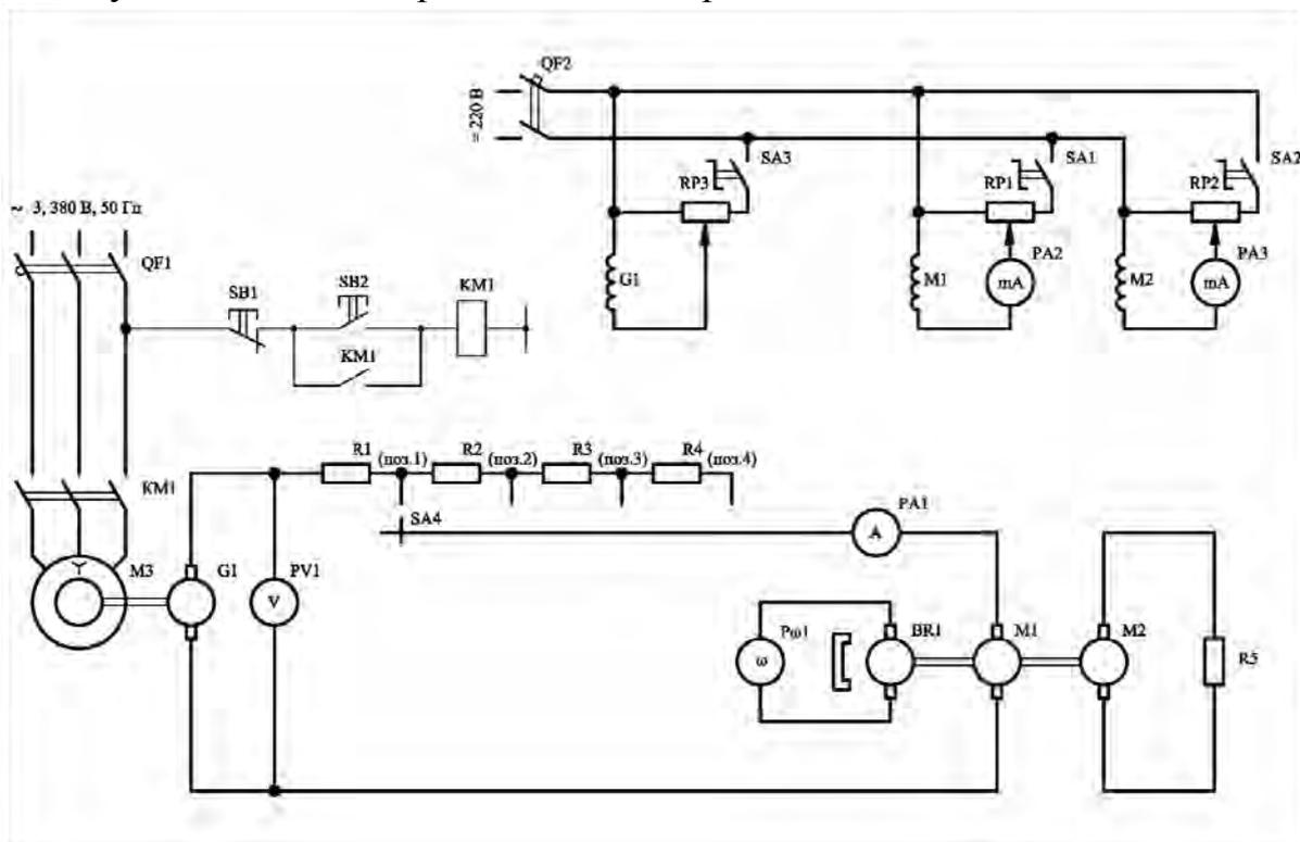
Рисунок 5 – Схема для исследования механических характеристик двигателя постоянного тока независимого возбуждения
