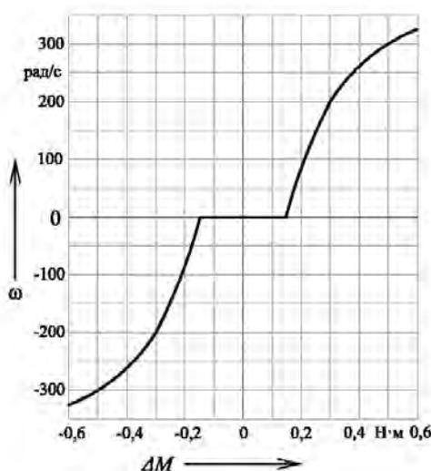
Рисунок 7 – Зависимость  $\Delta M = f(\omega)$  для двигателя М2 при номинальном токе возбуждения
