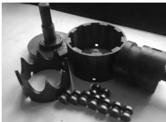
а – обкатка редуктора на токарном станке; б – основные детали передачи
