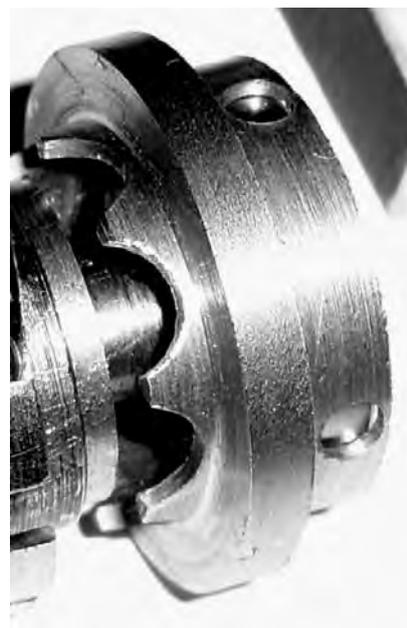
Рисунок 6.11 – Наружные кулачки с адаптированным профилем впадин
