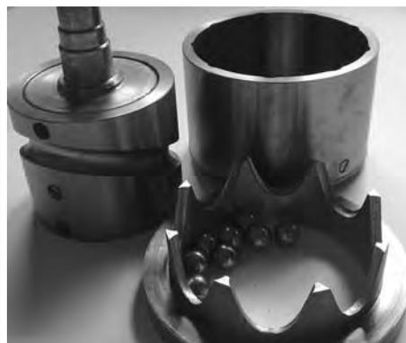
а – редуктор в сборе; б – основные детали передачи
