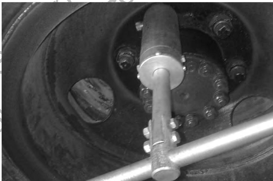
Рисунок 7.13 – Общий вид ключа для демонтажа ведущих колес грузовых автомобилей ЗИЛ и ГАЗ
