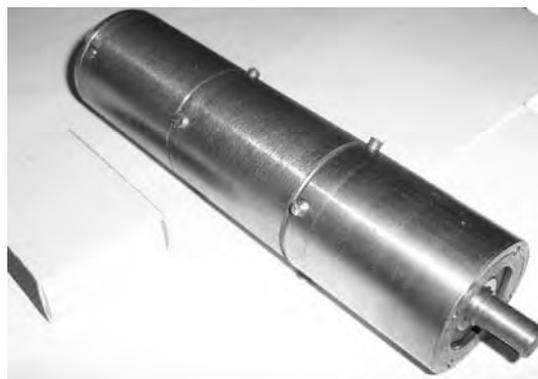
Рисунок 7.10 – Модули трехступенчатого редуктора для скважинного прибора (а) и редуктор в сборе (б)
