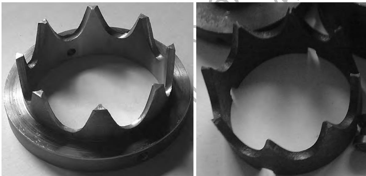
Рисунок 6.1 – Кулачки с периодическим профилем на торце
