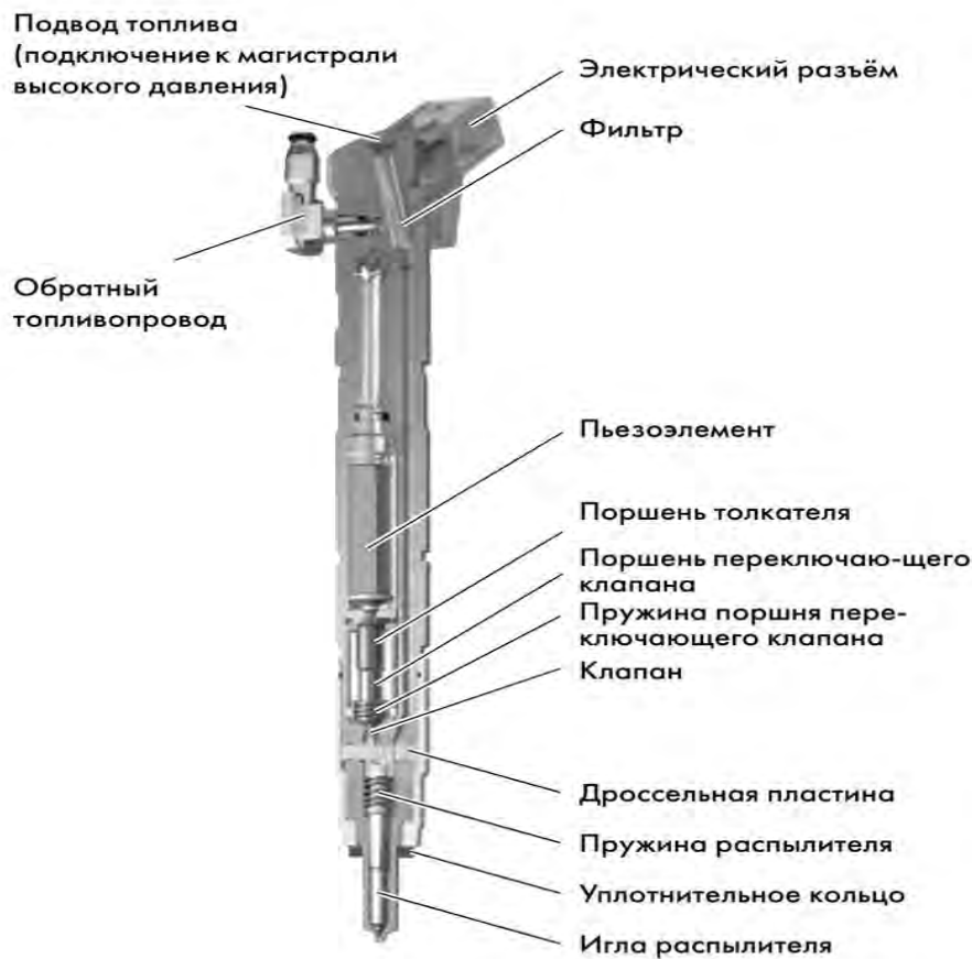
Рисунок 3 – Пьезоэлектрическая форсунка
