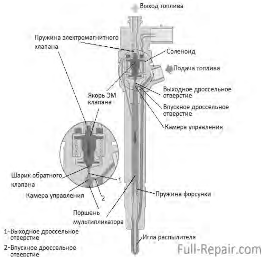
Рисунок 1 – Схема электромагнитной форсунки Bosch
