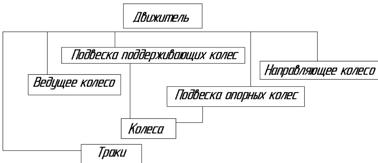
Рисунок 4.1 – Структурная схема гусеничного движителя
