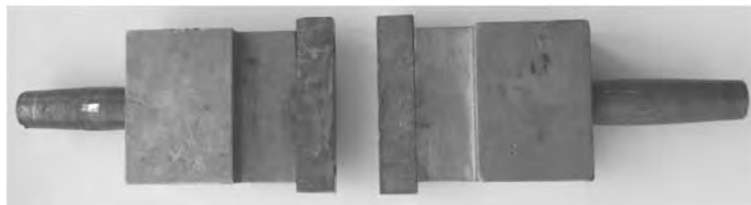
Рисунок 6.4 – Составной электродный узел для сварки засова
