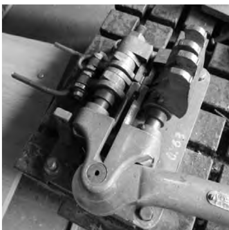
Рисунок 5.2 – Комбинированный прижим эксцентрикового типа
