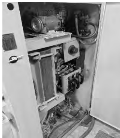
Рисунок 8.2 – Машина КШС типа МШ-1601 (а) и ее электрическая часть (б)
