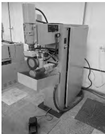
Рисунок 8.2 – Машина КШС типа МШ-1601 (а) и ее электрическая часть (б)
