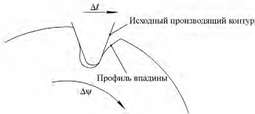
Рис. 1. Моделирование процесса зубообработки методом обката
