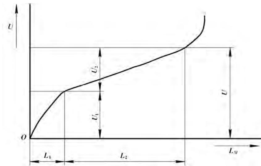
Рисунок 1.3 – График зависимости размерного износа от пути резания
