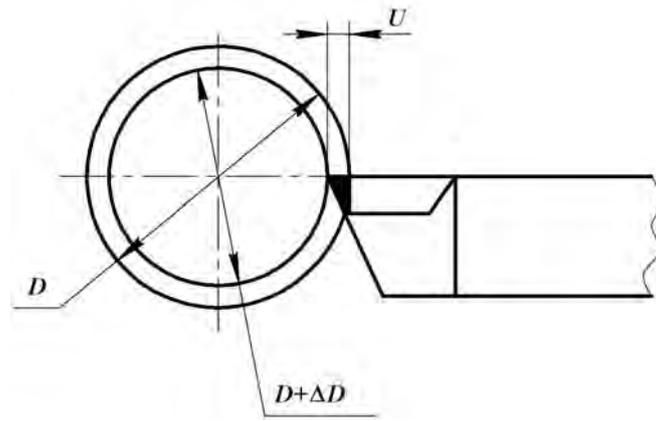
Рисунок 1.2 – Схема формирования поверхности с учетом износа реза
