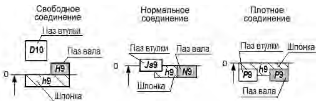
Рисунок 8.4 – Поля допусков шпоночных соединений по ширине паза (шпонки)
