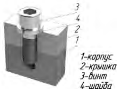
Рисунок 48 – Наглядное изображение соединения винтом
