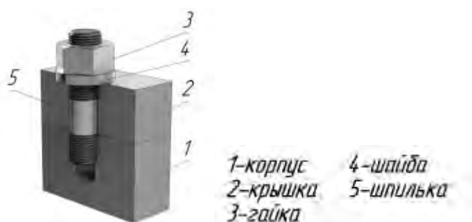
Рисунок 44 – Наглядное изображение соединения шпилькой
