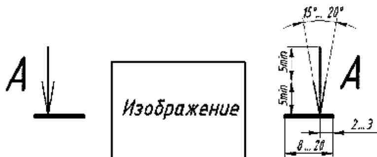
Рисунок 12 – Обозначение разреза
