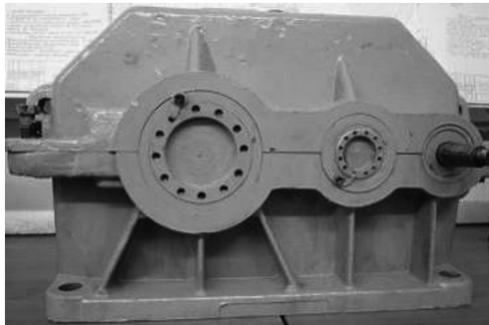
Рис. 15.5. Общий вид корпуса редуктора с ребрами жесткости
