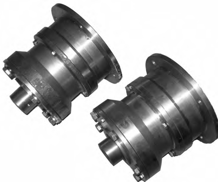
Рисунок 3.25 – Общий вид прецессионных мотор-редукторов для установки на нории
