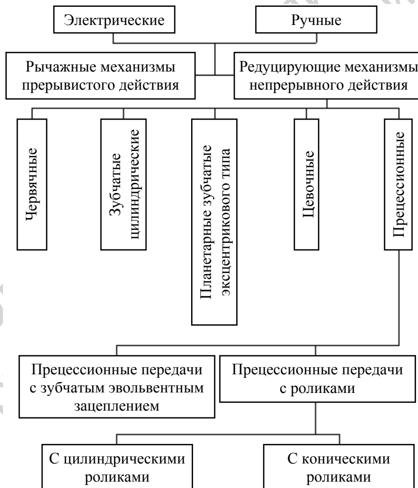
Рисунок 1.11 – Классификация лебедок, применение которых возможно в аварийно-спасательных устройствах
