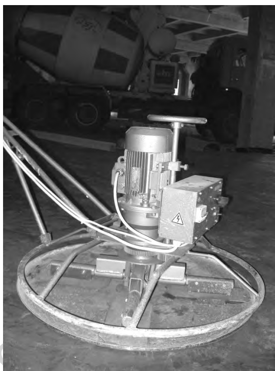
Рисунок 3.5 – Внедрение прецессионных мотор-редукторов в конструкцию заглаживающих машин СО-170, использующихся при выполнении работ по заглаживанию бетона на предприятии «Борисовский хрустальный завод»
