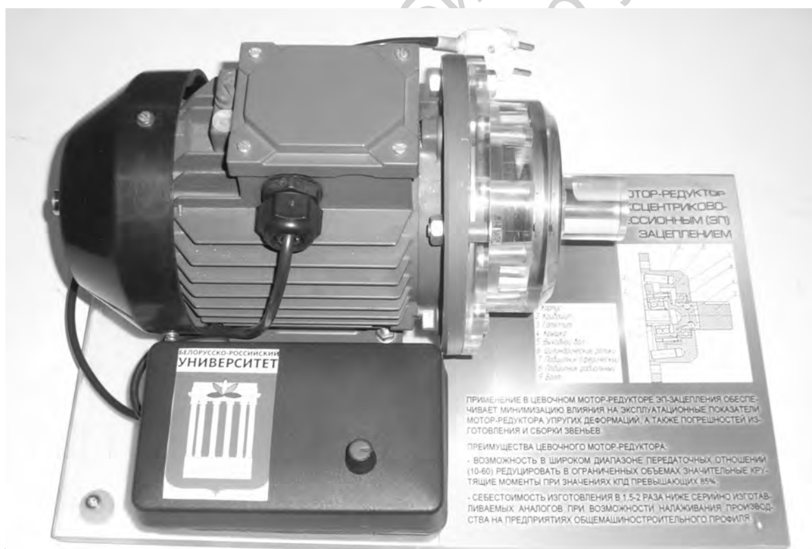
Рисунок 2.110 – Макетный образец перспективной конструкции мотор-редуктора, выполненного на базе прецессионной передачи
