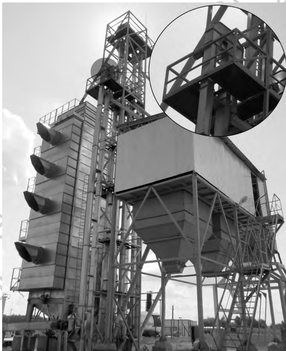
Рисунок 3.31 – Зерноочистительно-сушильный комплекс КЗСК-30 на КСУП «Экспериментальная база «Дашковка» с установленным мотор-редуктором в качестве привода нории
