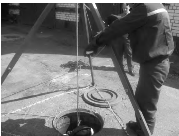
Рисунок 1.58 – Эксплуатационные испытания устройства, разработанного на базе лебедки с прецессионным редуцирующим механизмом
