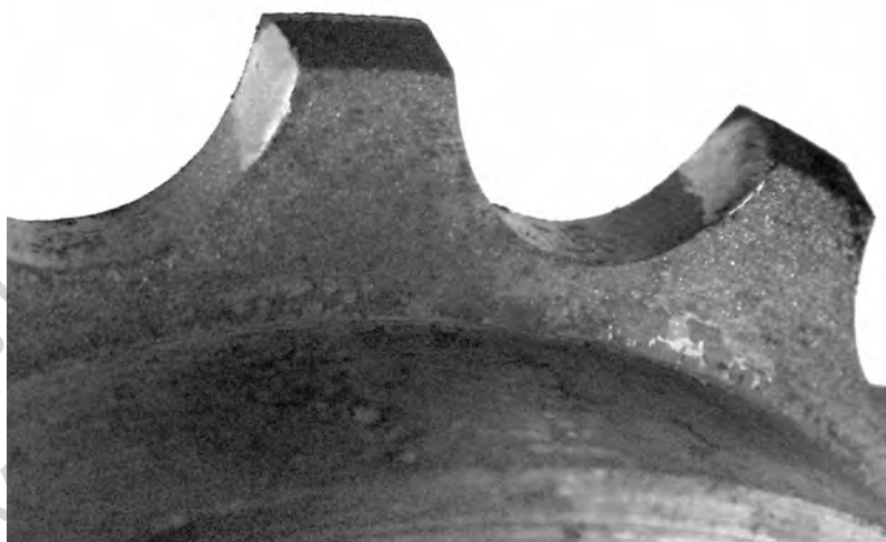
Рисунок 1.55 – Контактирующие поверхности зубьев реборды барабана после проведения ресурсных испытаний
