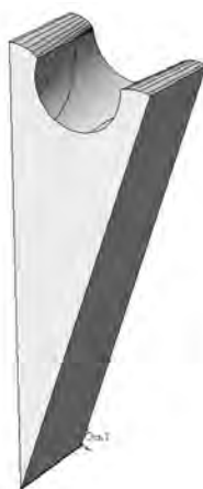
Рисунок 2.58 – Впадина создаваемого зуба сателлитного колеса
