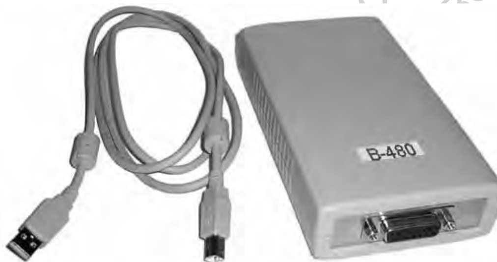
Рисунок 2.97 – Общий вид АЦП В-480
