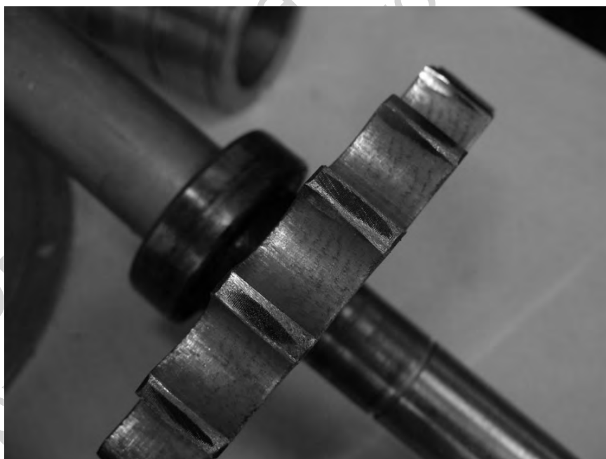
Рисунок 2.106 – Неподвижная звездочка прецессионного редуцирующего механизма
