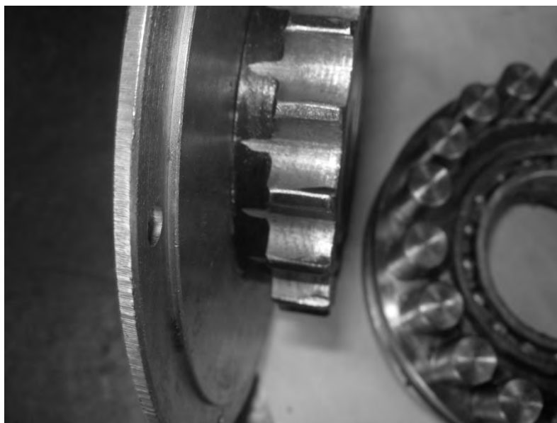
Рисунок 2.107 – Подвижная звездочка прецессионного редуцирующего механизма
