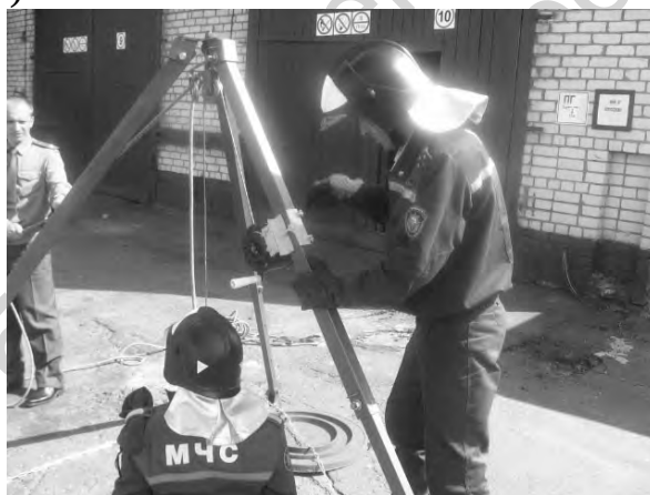
Рисунок 1.58 – Эксплуатационные испытания устройства, разработанного на базе лебедки с прецессионным редуцирующим механизмом
