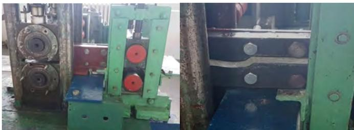
Рис. 1. Установка совмещенного процесса «прокатка – РКУП»
