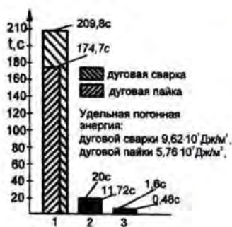
Рисунок 2 – Время пребывания металла покрытия при температурах окисления (1), плавления (2), кипения (3)
