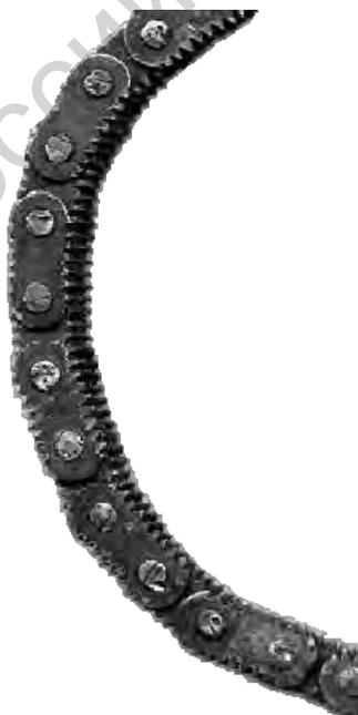
Рисунок 2.34 – Фрагмент мелко модульной пластинчатой зубчатой цепи (число зубьев 164, модуль 0,5 мм, число пластин в звене цепи 14)
