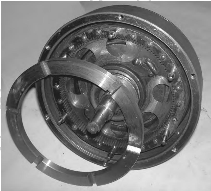
Рисунок 2.44 – Редуктор с деформируемым разрезным колесом (см. рисунок 2.43)
