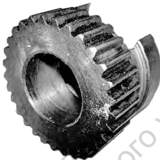
Рисунок 1.53 – Сателлит с зубьями, изготовленными инструментом с 30-градусным исходным контуром
