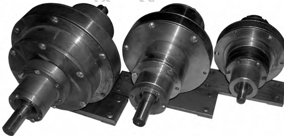
Рисунок 1.57 – Три опытных образца редуктора типового ряда с модулями зубчатых колес тихоходной ступени 1,25; 1,5; 2 мм
