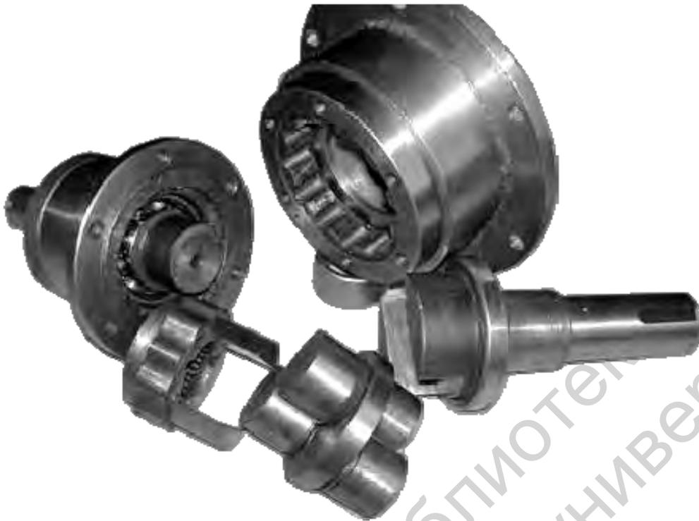
Рисунок 3.11 – Детали опытного образца планетарного редуктора с циклоидально-цевочным зацеплением с «плавающими» цевками
