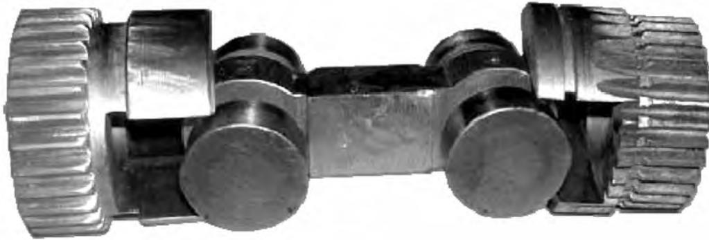
Рисунок 1.39 – Опытный образец пальцевого кардана, соединяющего две шестерни
