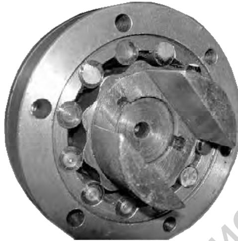
Рисунок 3.10 – Фрагмент циклоидально-цевочной передачи с «плавающими» цевками
