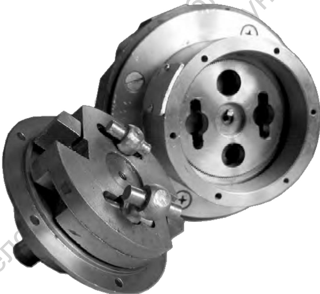
Рисунок 1.42 – Реализованный макет мотор-редуктора с двумя короткими пальцевыми карданами по схеме рисунка 1.40
