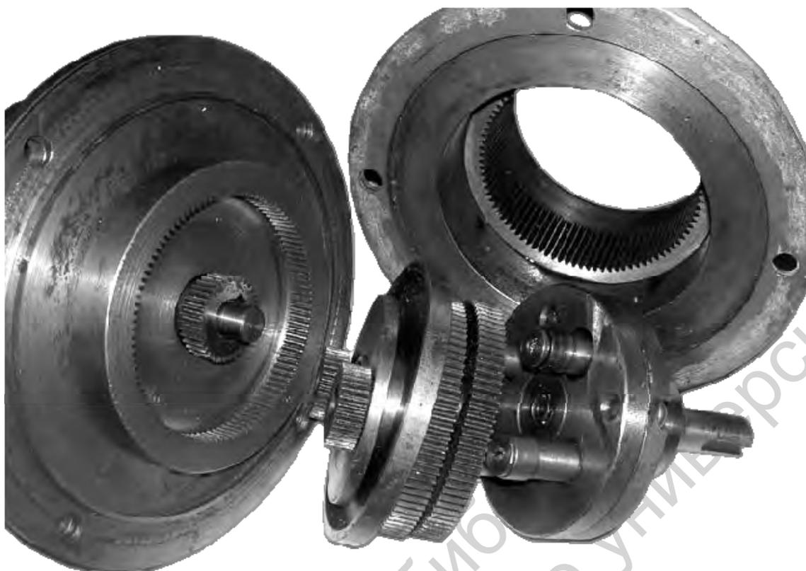
Рисунок 1.48 – Опытный образец двухступенчатого планетарного механизма комбинированной схемы с передаточным отношением 360
