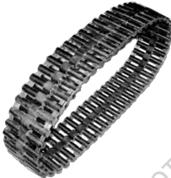
Рисунок 2.27 – Опытный образец пальцевой цепи с шагом 9,525 мм и числом пальцев 55
