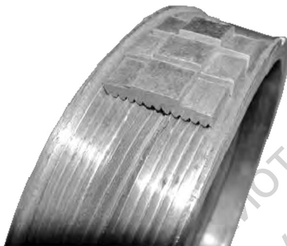
Рисунок 2.20 – Фрагмент рабочего узла фрикционного планетарного редуктора со сборным поликлиновым ремнем
