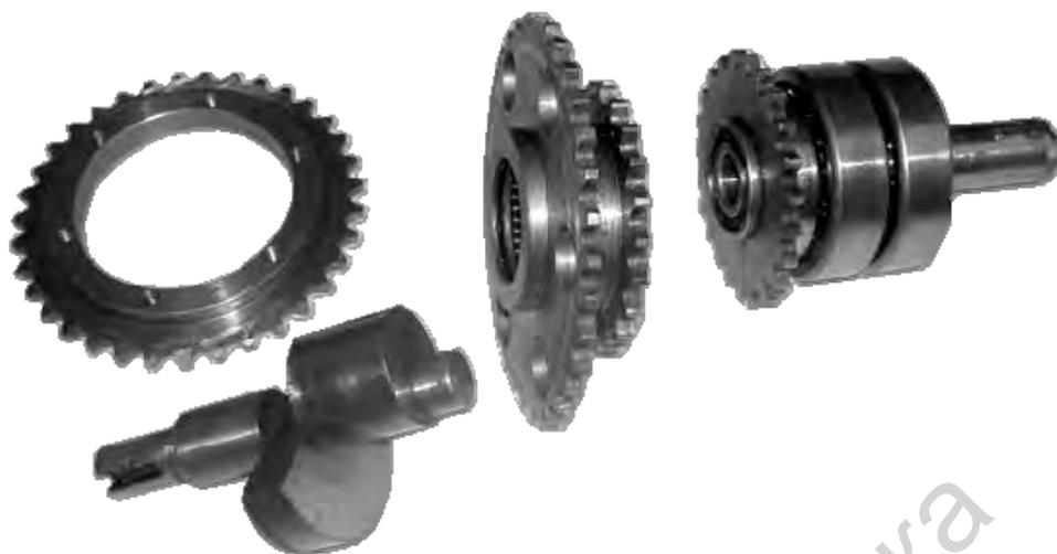
Рисунок 2.30 – Детали цепного планетарного редуктора (см. рисунок 2.29)
