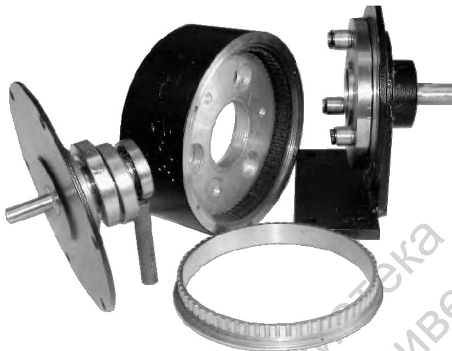
Рисунок 2.10 – Макет планетарного механизма с полиуретановым зубчатым ремнем в разобранном виде с числом зубьев 68 и шагом зубьев 5,08 мм
