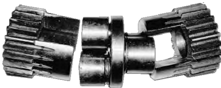
Рисунок 1.31 – Вариант конструкции крестовой муфты с втулками (видны соединяемые шестерни)
