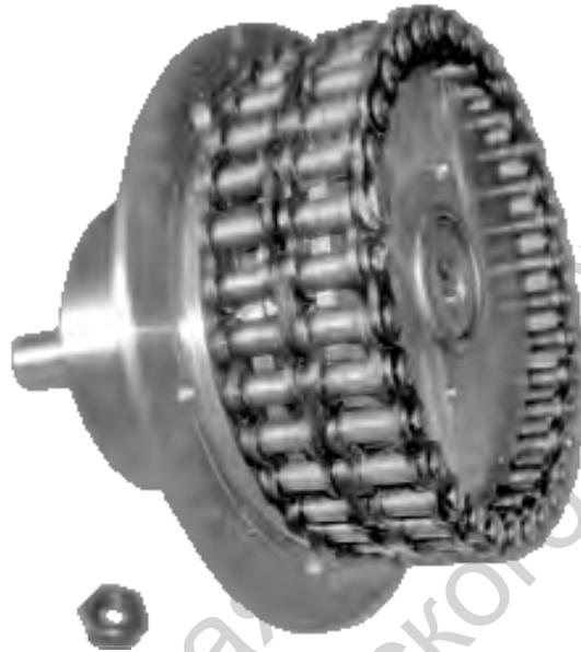
Рисунок 2.28 – Общий вид редуцирующего узла цепного планетарного редуктора с двумя звездочками с усиленным вариантом роликовой цепи и передаточным отношением 32
