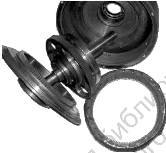
Рисунок 2.40 – Детали экспериментального образца двухколесного планетарного механизма с зубчатой цепью (см. рисунок 2.38). Разрезное зубчатое колесо с модулем 1 мм, число зубьев цепи 142, числа зубьев звездочек 141 и 140
