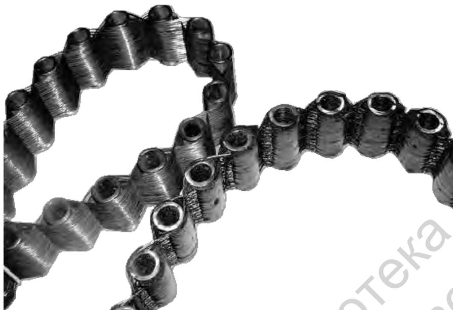
Рисунок 2.17 – Вид арматуры ремня и ремня после нанесения резинового покрытия
