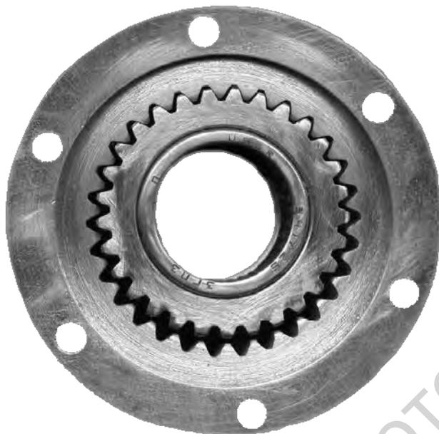
Рисунок 1.27 – Реализованная передача с внутренним зацеплением с модулем 1,5 мм и разностью чисел зубьев в один зуб и колесами, изготовленными инструментом с 30-градусным исходным контуром
