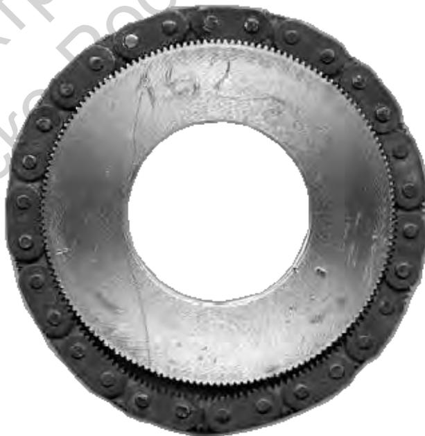
Рисунок 2.36 – Сборка мелко модульной пластинчатой зубчатой цепи и сателлита
