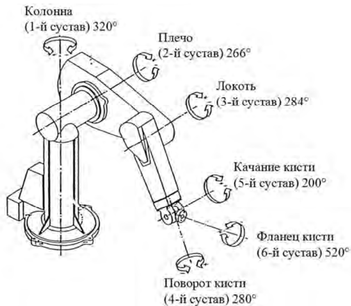
Рисунок 4 – Степени подвижности манипулятора
