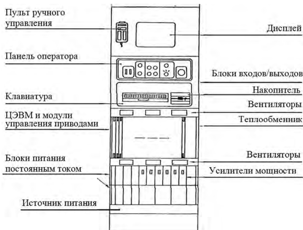
Рисунок 5 – Основные модули системы управления «СФЕРА-36»
