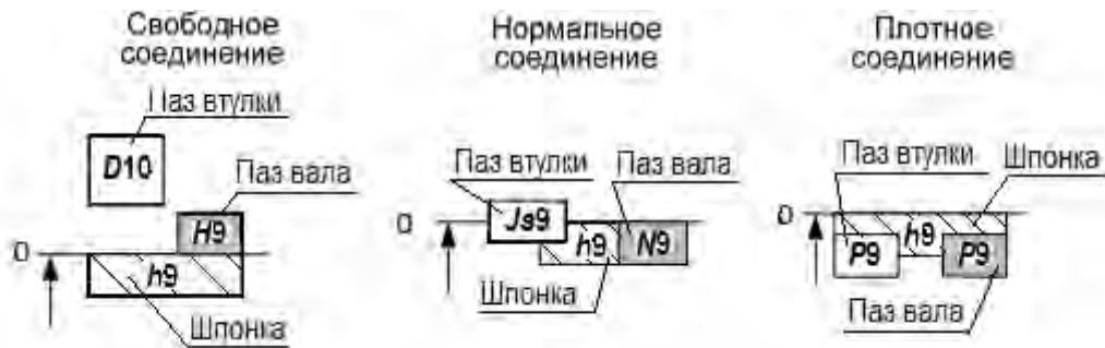
Рисунок 7.4 – Поля допусков шпоночных соединений по ширине паза (шпонки)
