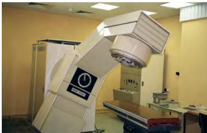
Рисунок 3.2 – Медицинский линейный ускоритель электронов ЛУЭР-20М
