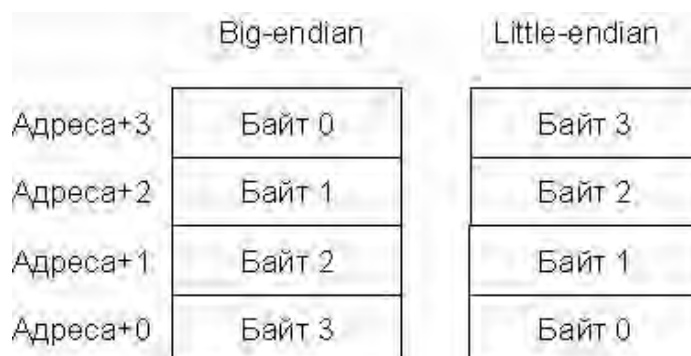
Рисунок 2.7 – Пример размещения байтов слова в памяти
