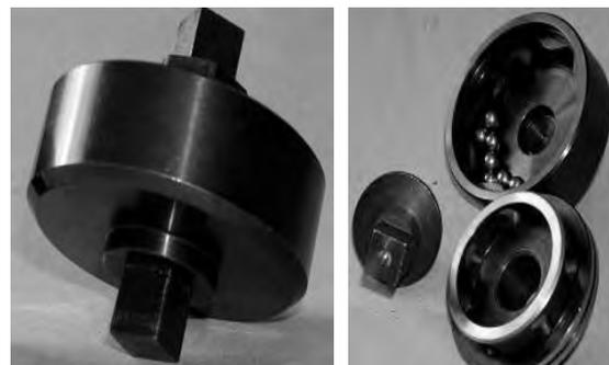
Рис. 6. Общий вид и детали усилителя момента к гаечным ключам
