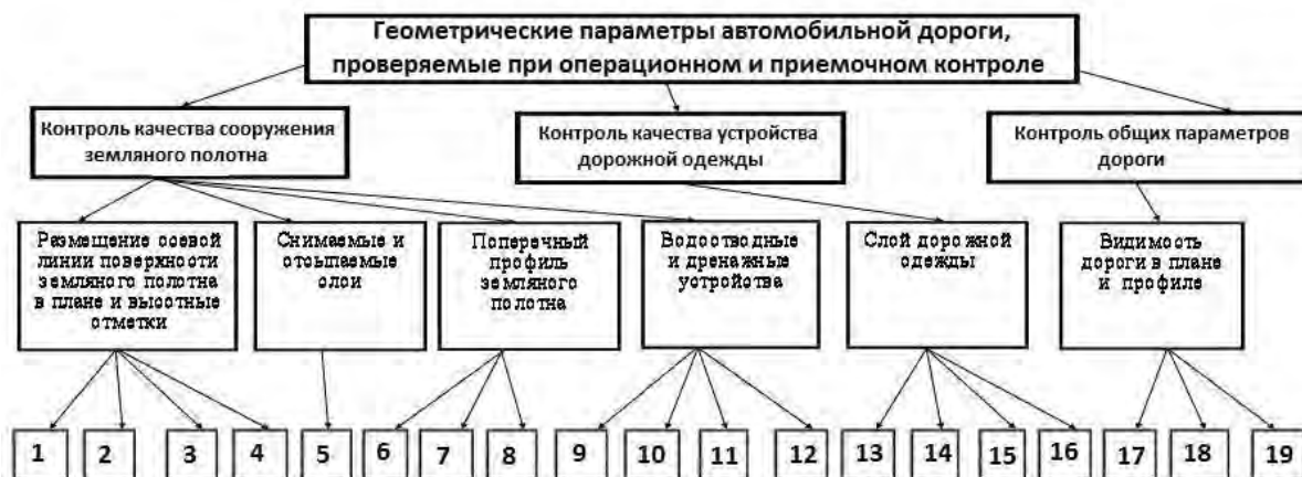
Рис. 1. Контролируемые геометрические параметры автомобильной дороги: 1 – длина прямых участков, углы поворота трассы; 2 – радиусы кривых в плане; 3 – радиусы вертикальных кривых; 4 – уклоны и отметки продольного профиля; 5 – толщина слоев; 6 – расстояние между осью и бровкой; 7 – поперечный уклон; 8 – крутизна откосов; 9 – поперечные размеры канав по дну; 10 – поперечные размеры дренажей; 11 – продольные уклоны дренажей; 12 – ширина насыпных берм; 13 – высотные отметки по оси дороги; 14 – ширина слоев; 15 – толщина слоев; 16 – поперечные уклоны; 17 – видимость на пересечениях в одном уровне; 18 – видимость на горизонтальных кривых; 19 – видимость на вертикальных кривых
