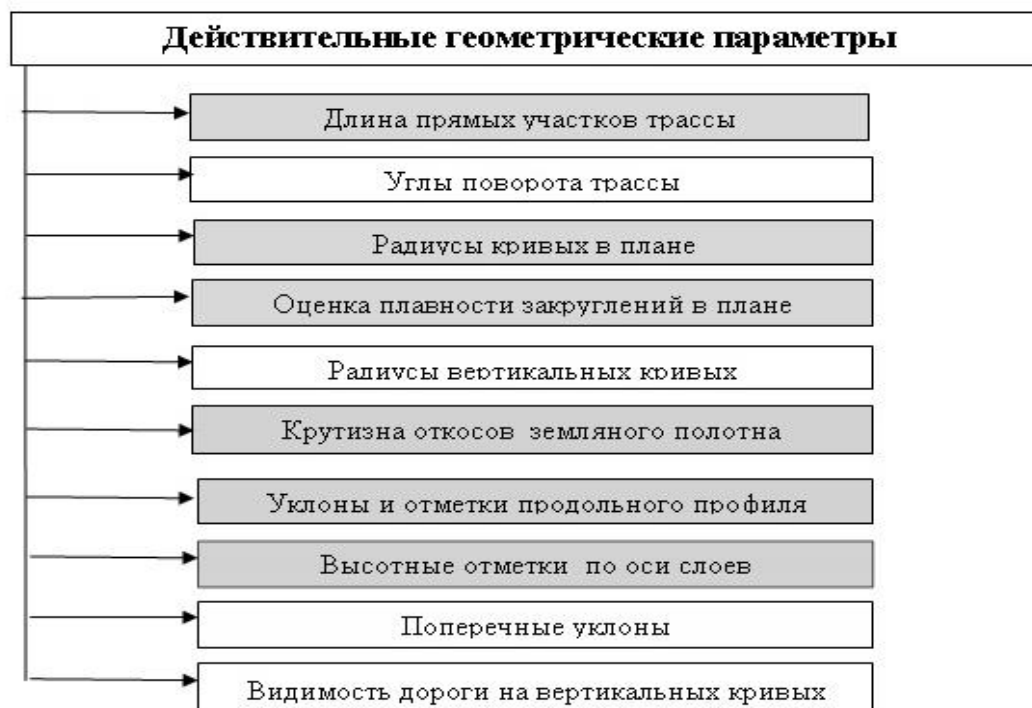
Рис. 2. Действительные геометрические параметры, определяемые с помощью электронного тахеометра
