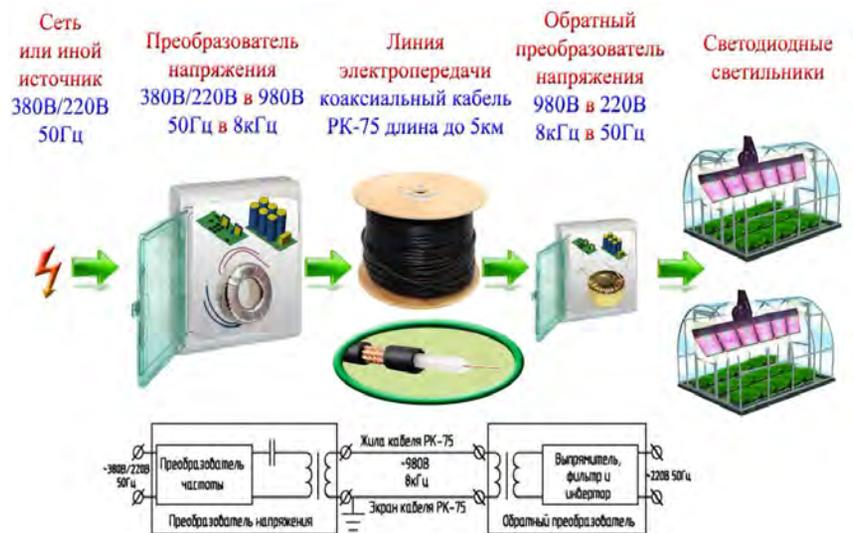
Рис. 1. Резонансная система электропитания для облучения растений
