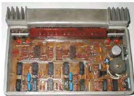
Рисунок 5.23 – Элементная база 4-канального электронного блока управления новой АБС с индивидуальным регулированием каждого колеса (IR)
