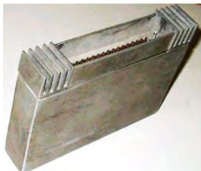
Рисунок 5.24 – Общий вид 4-канального электронного блока управления новой АБС с индивидуальным регулированием каждого колеса (IR)
