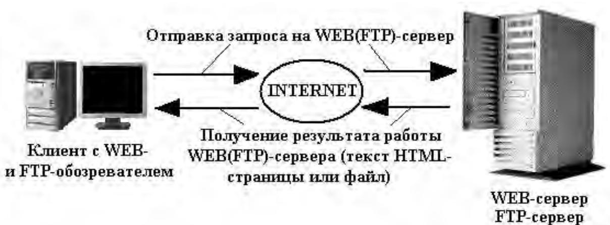
Рисунок 9.1 – Схема работы WEB- и FTP-сервера
