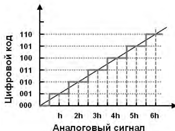
Рисунок 4.1 – Идеальное квантование аналогового сигнала
