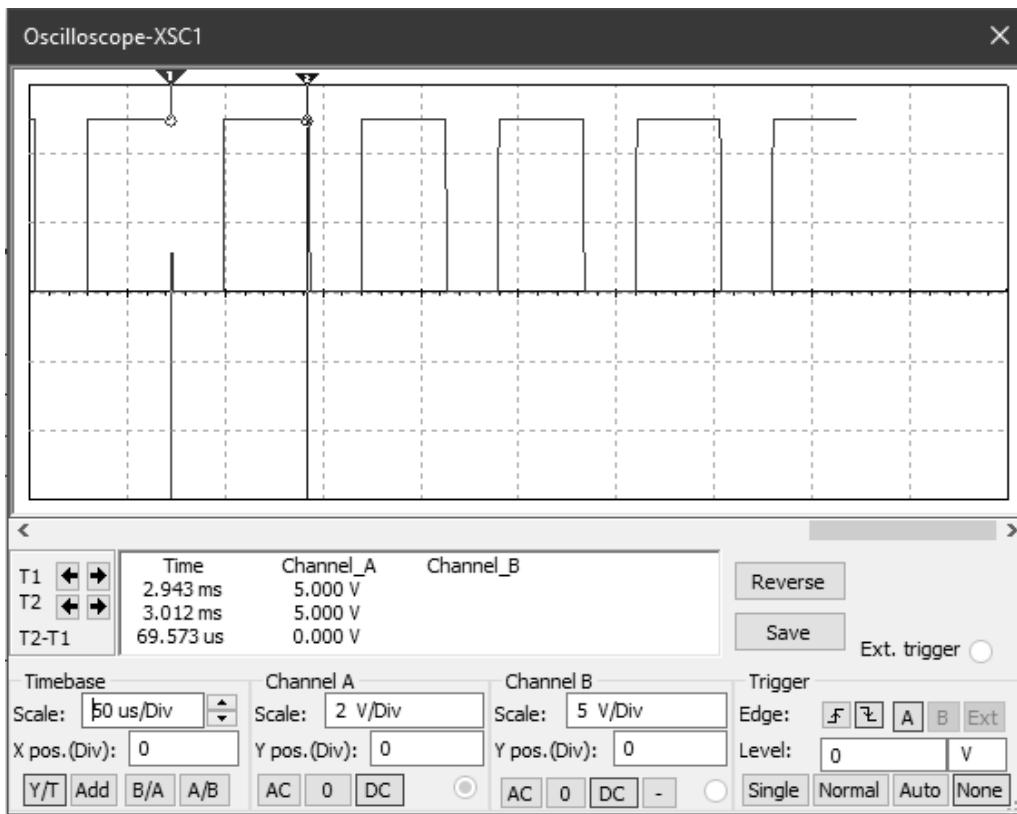
Рисунок Б.7 – Временная диаграмма работы генератора в Multisim
