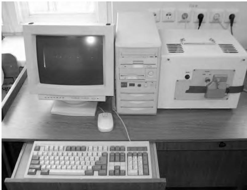
Рис. 1. Программно-аппаратный комплекс для магнитографического контроля
