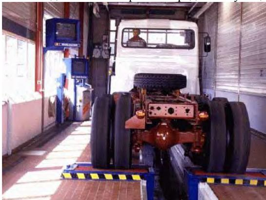
Рис. 1. Роликовый тормозной стенд для грузовых автомобилей с максимальной нагрузкой на ось до 18 т IW 7/Е немецкой фирмы «МАНА»
