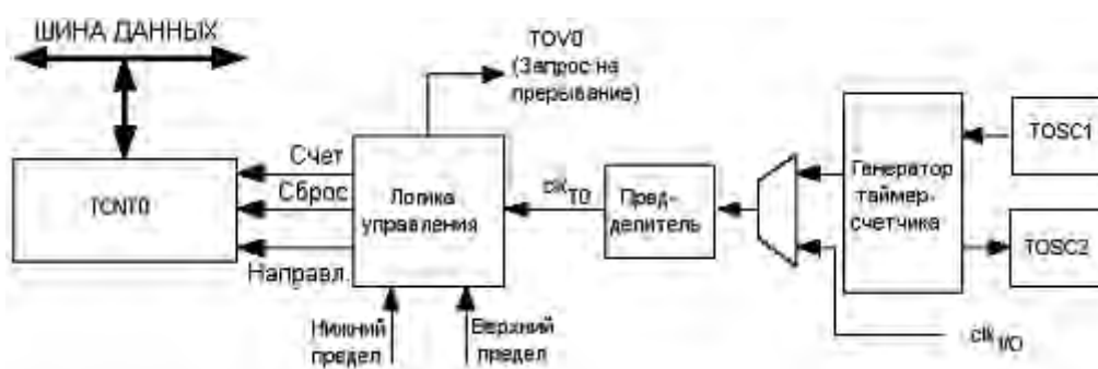
Рисунок 3.2 – Функциональная схема счетчика
