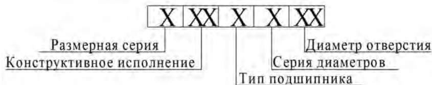
Рисунок 9.2 – Обозначение подшипника
