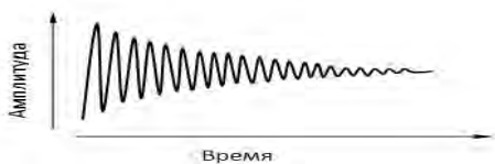
Рисунок 13.3 – Характер изменения сигнала, обусловленного возвращением прецессирующего вектора \vec{M} в положение, параллельное оси Z
