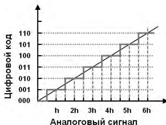
Рисунок 4.1 – Идеальное квантование аналогового сигнала
