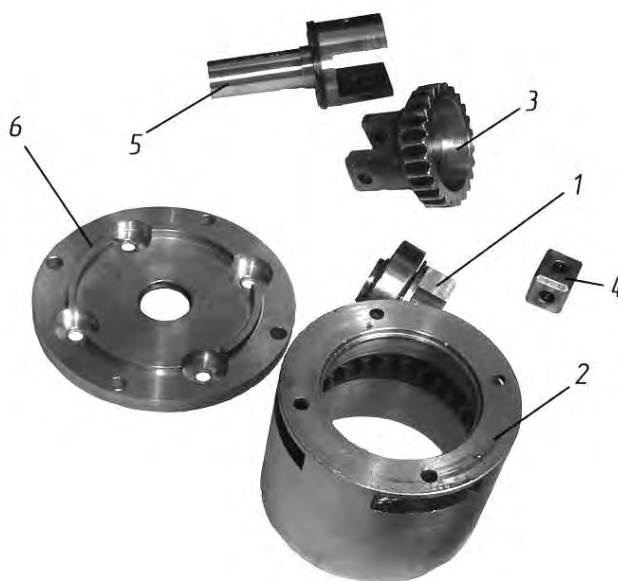
Рис. 3. Основные детали редуктора
