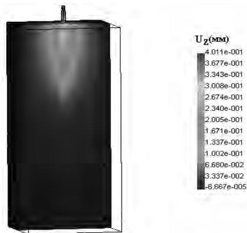
Рис. 2. Распределение перемещений по объему модели при фиксации бетона высотой 500 мм
