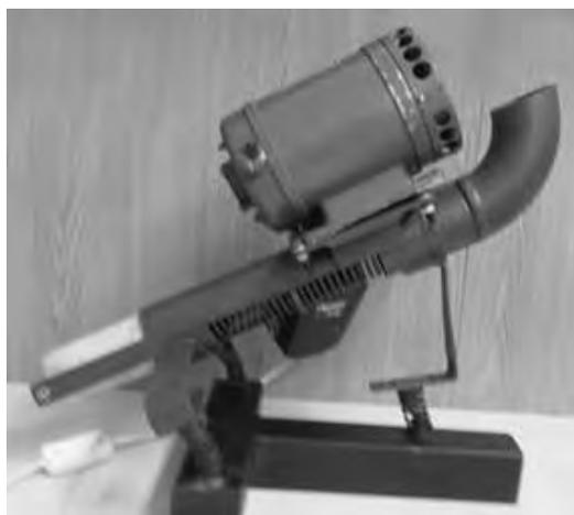
Рис. 1. Экспериментальная установка пружинного грохота
