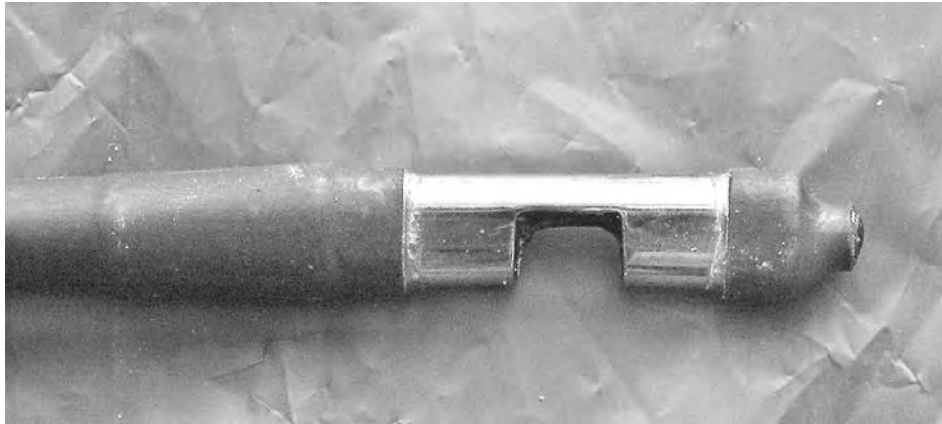
Рис. 6. Первичный преобразователь волоконно-оптического датчика с постоянной оптической базой 10 мм для контроля прозрачности гидравлического масла
