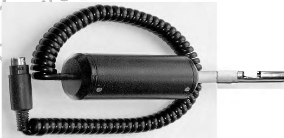
Рис. 8. Волоконно-оптический датчик прибора ИП-3М-2 с постоянной оптической базой 15 мм
