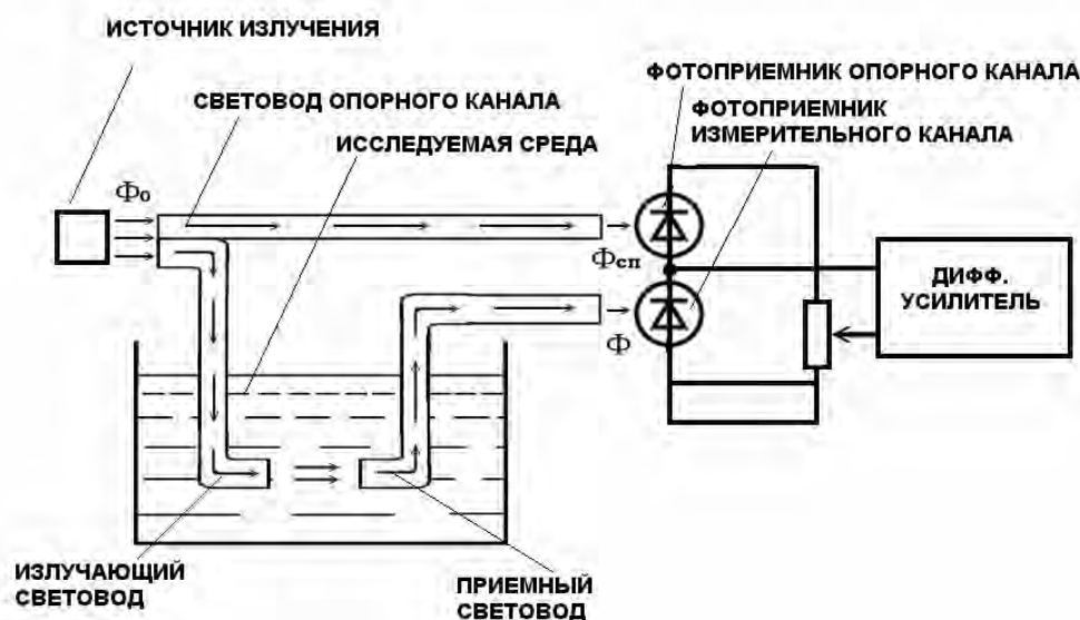
Рис. 3. Оптическая схема двухканального световодного датчика
