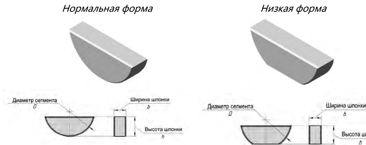
Рисунок 7 – Сегментные шпонки
