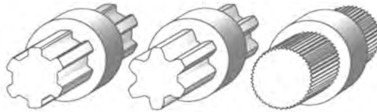
Рисунок 10 – Профиль зубьев шлицевых соединений
