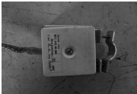
Рисунок 2.35 – Датчик тока ДТПХ-32000 ( а ) и его источник питания ( б )
