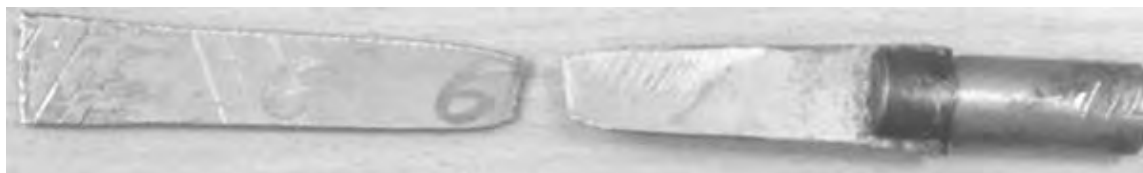
Рисунок 4.8 – Разрушенный образец по металлу ригеля (предлагаемый режим КРС)
