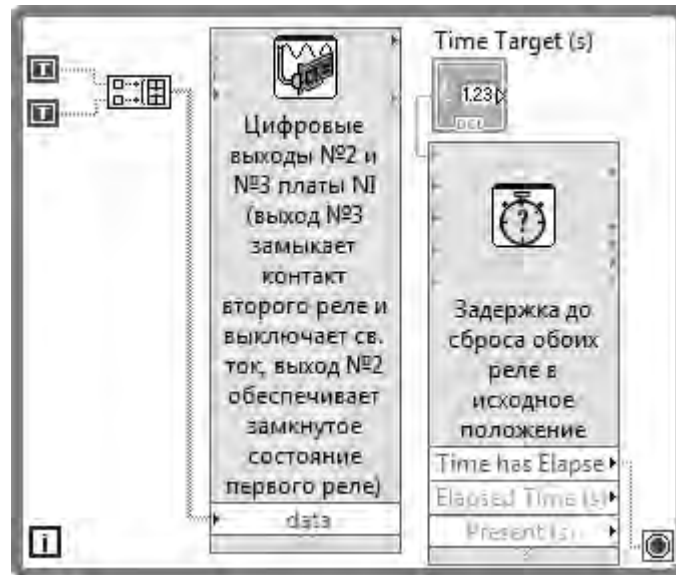
Рисунок 2.25 – Цикл запуска электромагнитного реле, отвечающего за фактическое выключение сварочного тока
