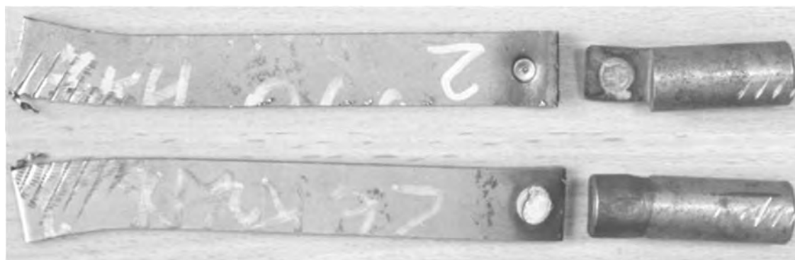
Рисунок 4.6 – Разрушенный образец после КРС на базовом режиме
