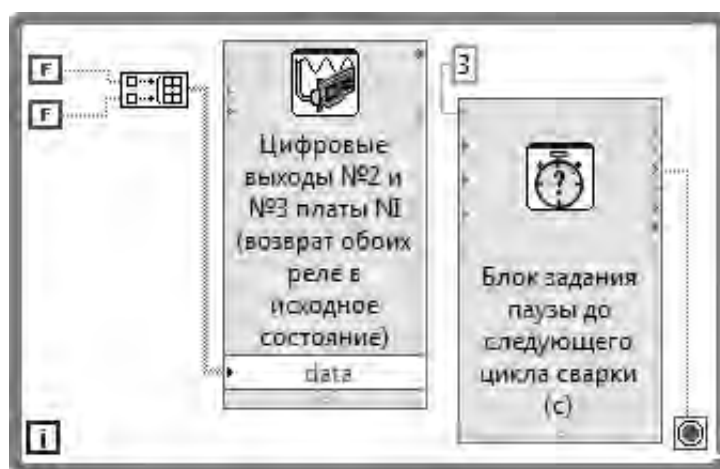
Рисунок 2.26 – Цикл сброса обоих электромагнитных реле в исходное состояние и задания программной паузы до следующего цикла КРС
