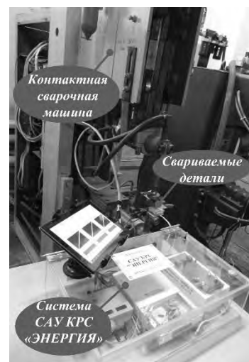
Рисунок 2.38 – Система САУ КРС «Энергия» (а) и ее подключение к сварочной машине (б)
