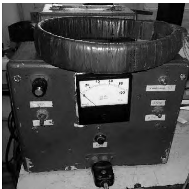
Рисунок 2.36 – Пояс Роговского и прибор для замера тока конденсаторного типа
