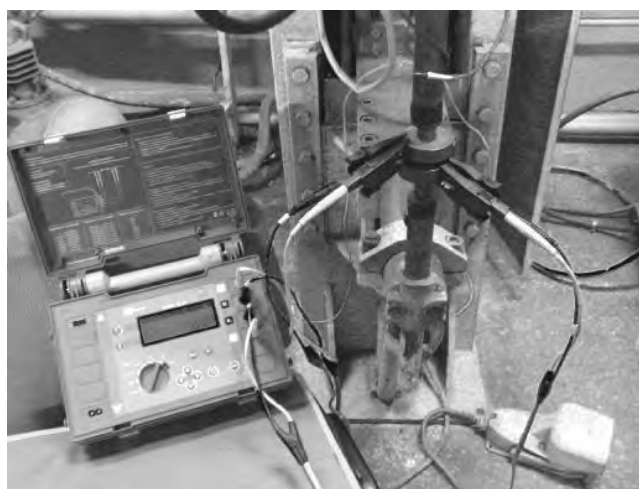
Рисунок 5.2 – Измерение активного сопротивления вторичного контура машины МТ-3201 цифровым микроомметром MMR-610
