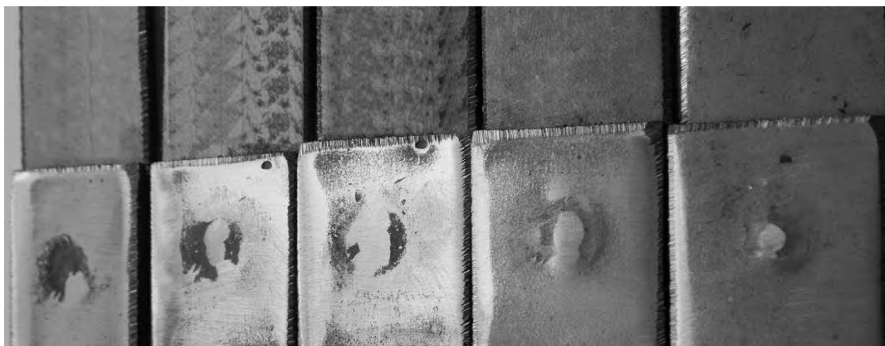
Рисунок 4.17 – Характер деформации лицевой поверхности детали без рельефа при КРС с уменьшением части расчетной энергии, вводимой на максимальном токе, на 5, 10, 20 и 30 % соответственно
