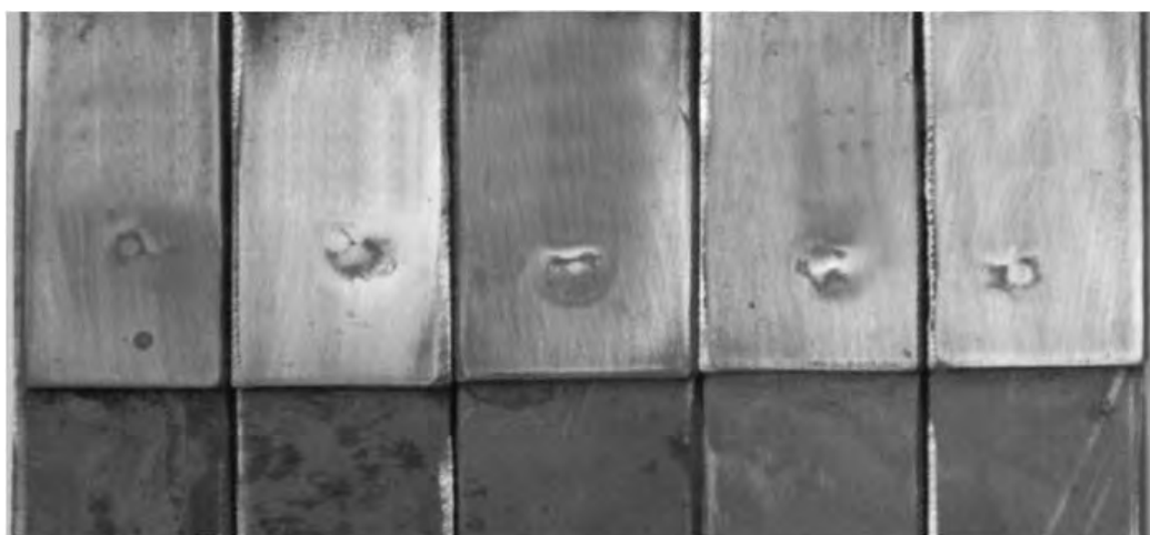
Рисунок 4.11 – Деформации лицевых поверхностей деталей, на которых перед процессом КРС был выштампован круглый сферический рельеф (нахлесточные соединения)
