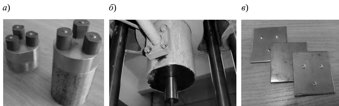
Рисунок 3.7 – Пуансоны с матрицами (а), испытательная машина (б) и штампованные образцы размером 70 × 70 мм (в)
