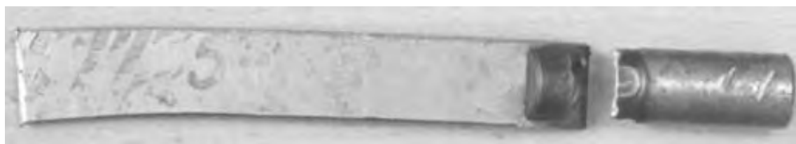
Рисунок 4.9 – Разрушенный образец по металлу стержня (предлагаемый режим КРС)
