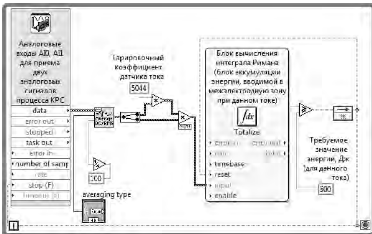
Рисунок 2.23 – Цикл регистрации и обработки двух аналоговых сигналов процесса КРС и отслеживания энергии, вводимой в межэлектродную зону
